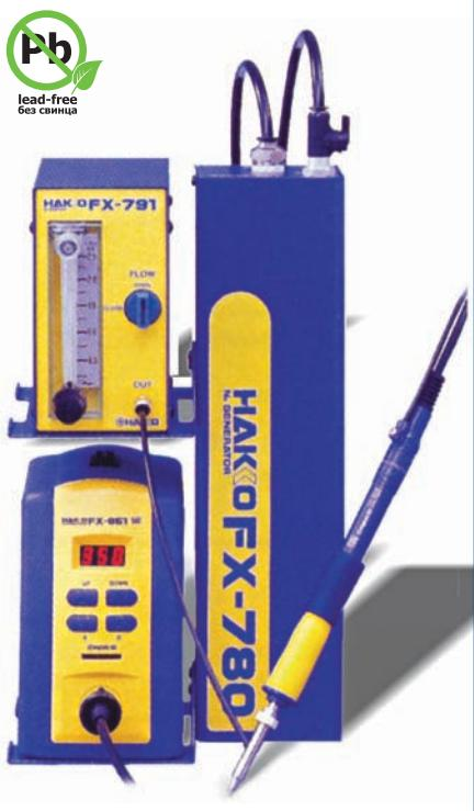
Пример комбинации станции с системой пайки в среде азота
